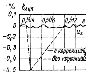
Рис. 6-14. Распределение погрешности АЦП около точки шкалы u_x \approx 0,512 в при коррекции и без нее
